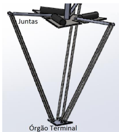
Figura 6: Juntas e órgão terminal
