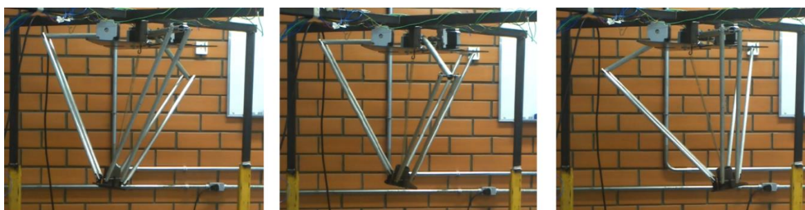
Figura 22: Teste de capacidade de carga com movimentação XY
