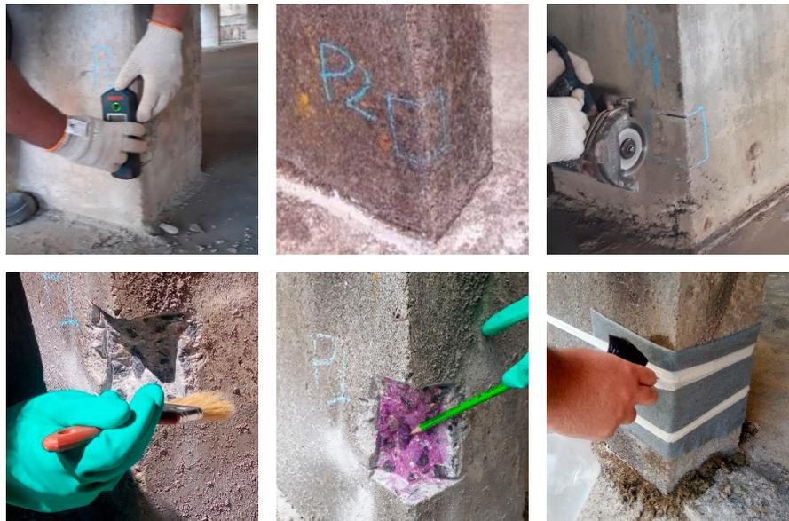
Para a determinação da profundidade de carbonatação dos pilares foram realizadas medições da área carbonatada em três pontos diferentes. A média entre os valores desses pontos foi adotada como parâmetro para aplicação no modelo.
