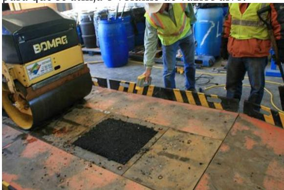
Figura 2 - Compactação das placas de misturas asfálticas utilizando rolo compactador, empregado na Universidade da Califórnia.
