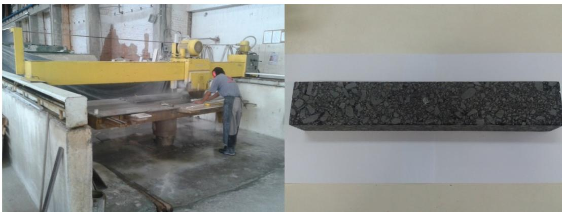
Figura 7 - Processo de corte das placas de mistura asfáltica para obtenção das vigotas.
