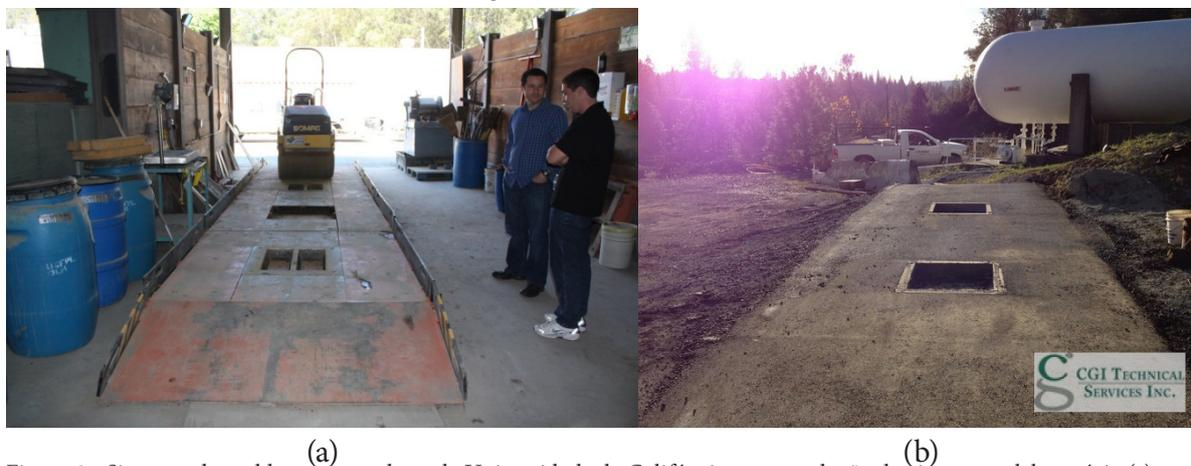
Figura 1 - Sistemas de moldes empregados pela Universidade da Califórnia para produção de vigotas em laboratório (a) e em campo (b) destinadas a ensaios de fadiga a quatro pontos.
