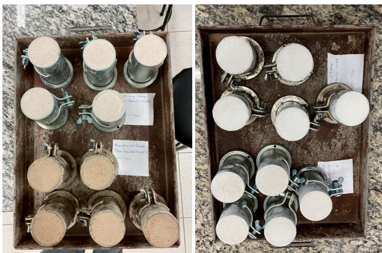
Figura 02: Moldagem dos corpos de prova (CPs)
