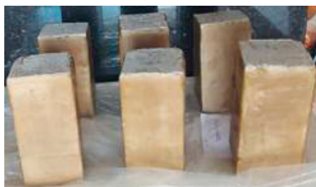
Figura 2. Exemplo de corpos de prova cortados e revestidos lateralmente com cera de abelha
